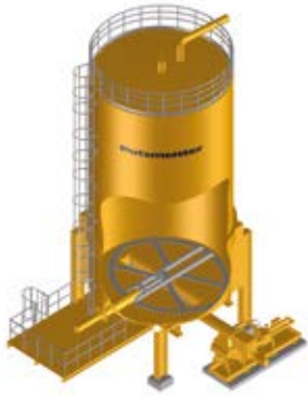
带滑架的储存仓, 用于给泵供料
