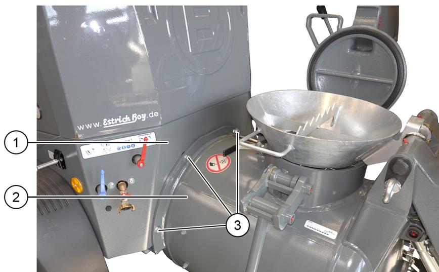
Abbildung 94: Schraubverbindung Mischbehälter, Rahmen
