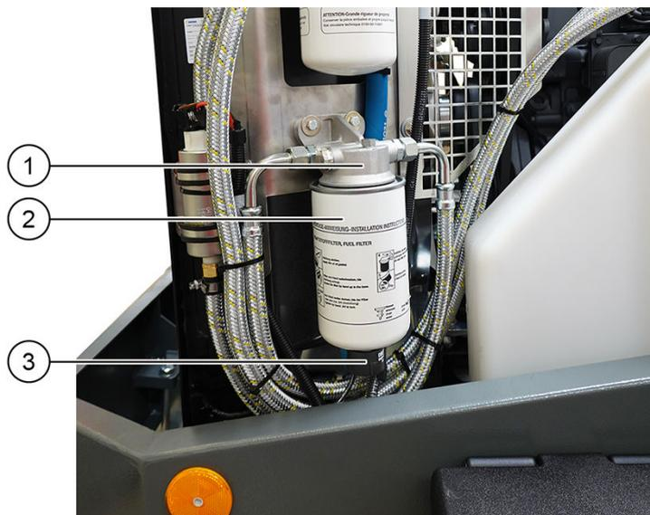
Abbildung 91: Kraftstoffvorfilter
