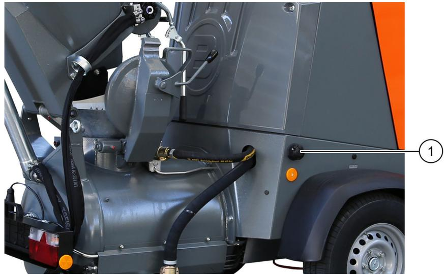
Abbildung 34: Steckdose Beleuchtungseinrichtung
