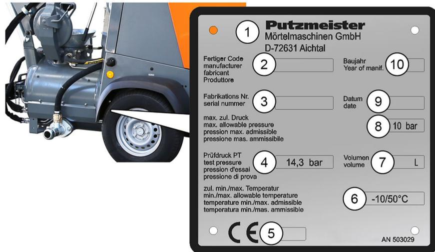
Abbildung 6: Typenschild Mischbehälter
