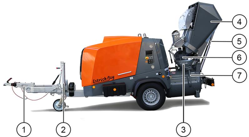
Abbildung 77: Schmierstellen an der Maschine
