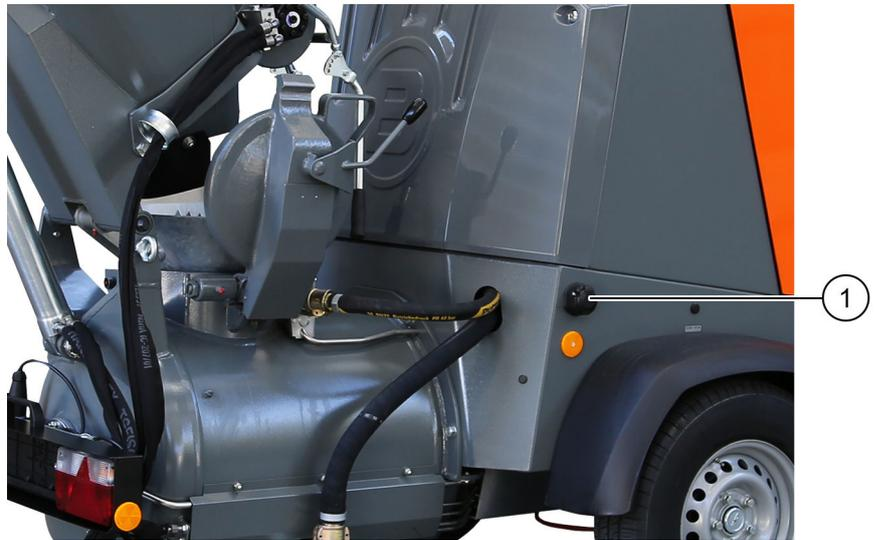
Abbildung 41: Steckdose Beleuchtungseinrichtung
