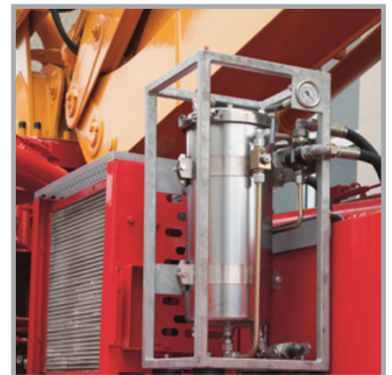
فلتر التدفق الإضافي هو عنصر اختياري للفلتر الدقيق في دائرة الزيت، وله تأثير كبير على جودة الزيت
