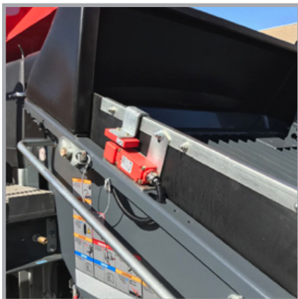
تجهيزة الفلق الآمن للقلاب هي تجهيزة قياسية عالمية في جميع آلات Putzmeister!
