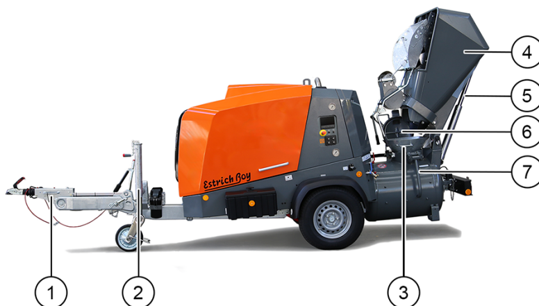
Slika 77: Mjesta podmazivanja na stroju
