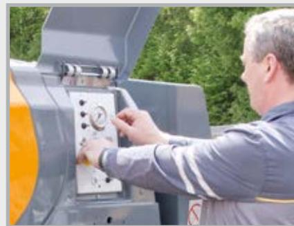
È possibile comandare la P 718 completamente da un lato, per es. per la regolazione continua della portata o dei giri del motore.
