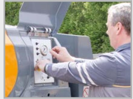
La P 718 se opera íntegramente desde un lateral, p. ej., para el ajuste sin escalonamientos del rendimiento o del número de revoluciones del motor.
