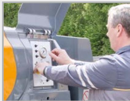
Все элементы управления P 718 расположены с одной стороны, например, бесступенчатая настройка объема подачи или частоты вращения двигателя.
