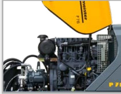
Mit zuverlässigem ölgekühltem 3-Zylinder Deutz-Dieselmotor (entspricht Abgasvorschrift Stage 3A).
