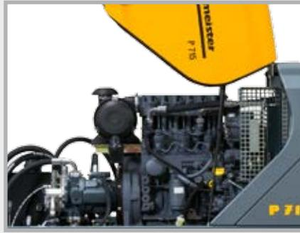
Dos variantes de motor: el fiable motor diésel Deutz tricilíndrico refrigerado por aceite (cumple la normativa de emisiones fase 3A) o el silencioso y ecológico motor eléctrico de 30 kW
