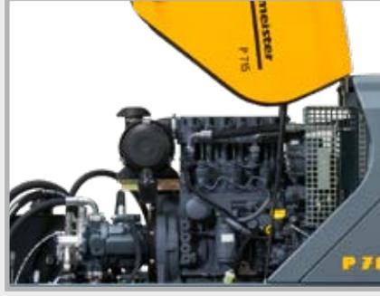
Güvenilir yağ soğutmalı 3 silindirli Deutz marka dizel motor (Stage 3A emisyon sınıfına uyumlu).
