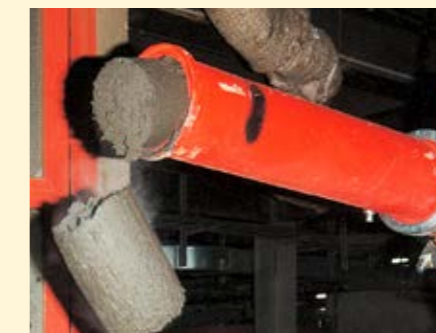
Klärschlamm aus Filterpressen und Zentrifugen
