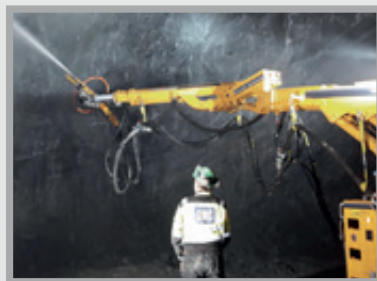
Sistema Hydroscaling opcional para la limpieza de la superficie.
