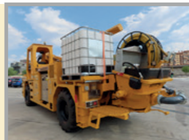
Bomba de hormigón Putzmeister de gran diámetro y larga carrera que minimizan las pulsaciones y aumentan la vida útil de los elementos de desgaste.
