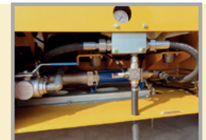
Bomba de aditivo de tornillo con caudalímetro asegurando un acabado de calidad.
