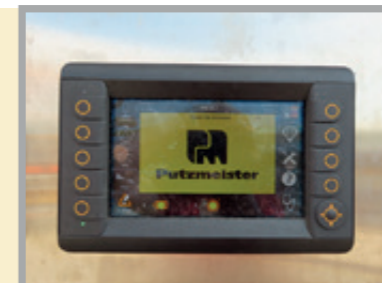
Software de control muy intuitivo a través de un display multilingüe a color. Permite ajustes de la dosificación de aditivos, indica el caudal de hormigón y diagnóstico de errores.
