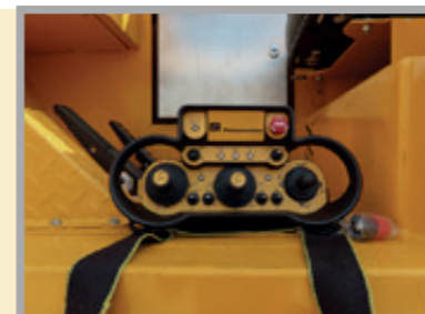
Control remoto dual, radio y cable, para un manejo fácil y preciso de los movimientos del brazo.
