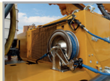
Sistema de limpieza incorporado de funcionamiento en diésel y en eléctrico.
