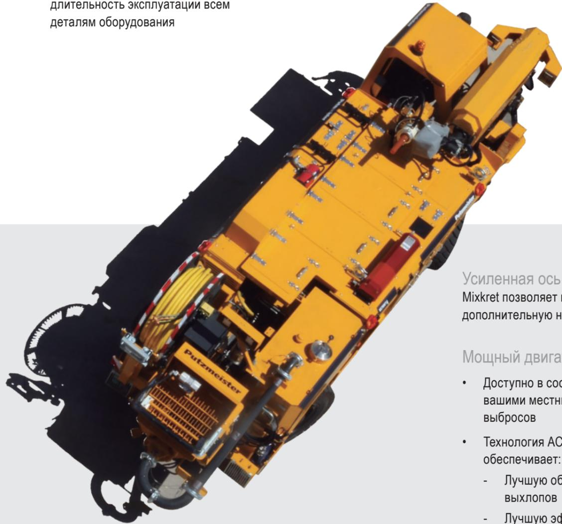
Усиленная ось линейки Mixkret позволяет выдерживать дополнительную нагрузку в 3000 кг.
