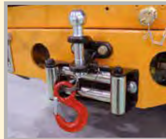
牽引カップリング (牽引力3.5ton)。急勾配での安全作業のための電動式ウインチ (牽引力6.3ton, ワイヤー50m)
