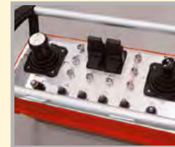
機器の操作を容易にする比例制御リモートコントロール、デュアル操作 (ケーブル/ラジコン)
