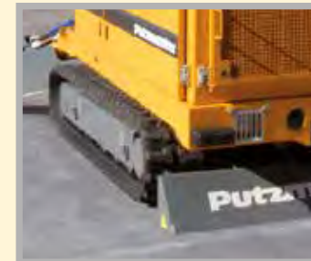
急な上り勾配での安全な作業のための油圧式リアブレード・スタビライザー
