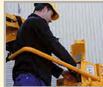
緊急時にクローラーを手動で制御するためのレバー
