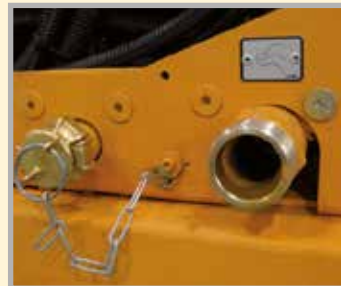
コンクリート、添加剤、エア供給用のクイックカップリング、機械の側面には、邪魔なホースがありません
