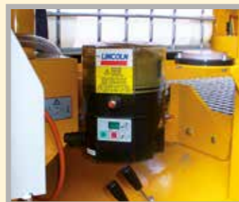
Sistema de engrase centralizado para el correcto mantenimiento del equipo.
