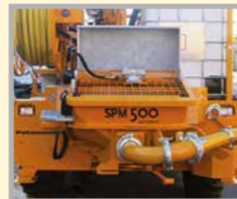
Su gran diámetro y larga carrera minimizan las pulsaciones y aumentan la vida de los elementos de desgaste de la bomba de hormigón.
