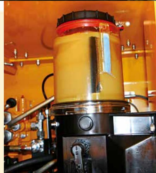
Automatische Schmierung für die korrekte Wartung des Geräts.
