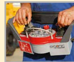
Proportionale Fernbedienung für eine einfache Handhabung der Armbewegungen, dual (Funk/ Kabel).
