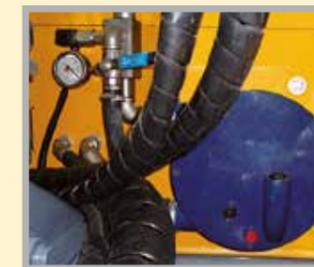
Zusatzmittelpumpe die mit der Durchflussleistung des Betons synchronisiert ist.
