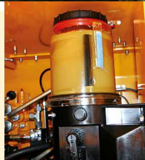
Sistema de engrase automático para el correcto mantenimiento del equipo
