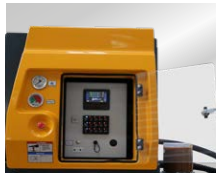
Tasten und Display mit Abdeckung geschützt
