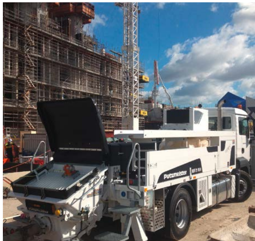
Tasten und Display mit Abdeckung geschützt
