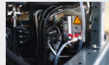
Hochdruck-Wasserpumpe mit Trockenlaufschutz
