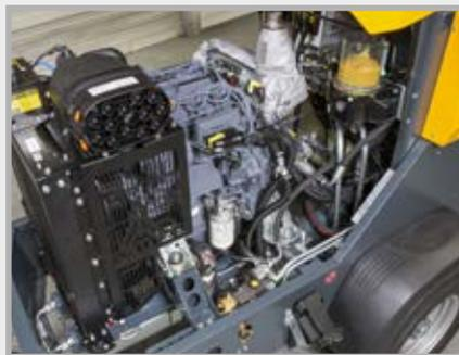
O potente motor de três cilindros da Deutz debita 55,4 kW graças ao arrefecedor do ar de sobrealimentação e satisfaz todos os requisitos da norma de emissões „Stage V“, aplicável na UE e na Suíça.
