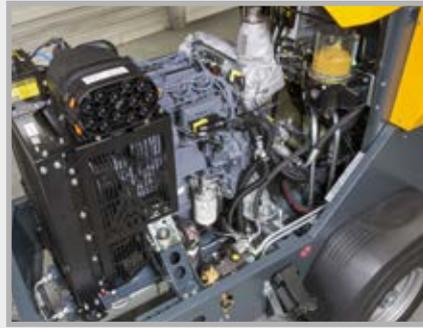
El motor Deutz potente de 3 cilindros de 55,4 kW gracias a los radiadores cumple todos los requisitos del estándar de emisiones aplicable «Stage V» de la UE y Suiza.
