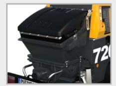
Grand trémie rabattable avec col en caoutchouc (280 I), grille de protection et dispositif anti-éclaboussures (en option) protection parfaite contre les projections de béton.
