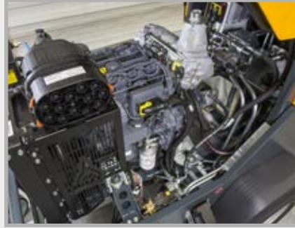
Robuster, kompakter Dieselmotor erfüllt alle Anforderungen des gültigen Emissionsstandards „Stage V“ in der EU sowie in der Schweiz.
