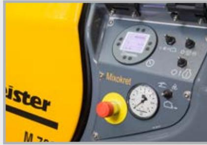
Luftarmatur, Instrumente und wichtige Anzeigen in Sicht- und Griffweite
