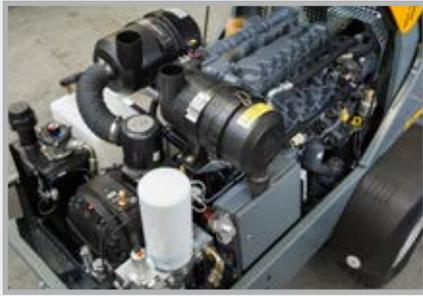
Moteur diesel 4 cylindres refroidi à l'huile avec compresseur performant pour un débit de pompage maximum et une puissance de réserve suffisante à l'exécution de tâches plus difficiles
