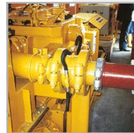
Oben: Gleitmittel-Dosierstation Rechts: Injektionsstelle für Gleitmittel
