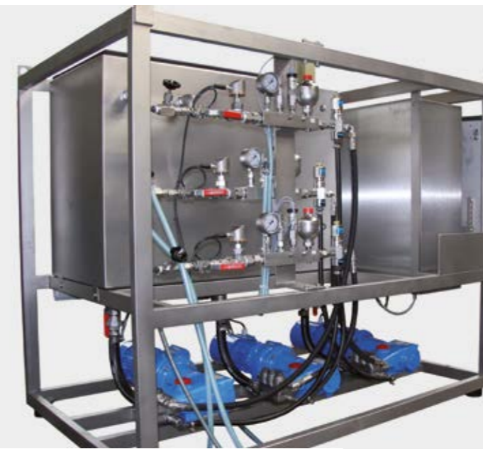
Oben: Gleitmittel-Dosierstation Rechts: Injektionsstelle für Gleitmittel
