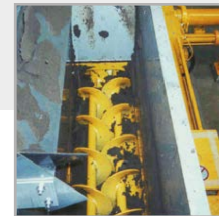
Doppelvorpresse-schnecken mit Mischpaddeln im Zulaufschacht
