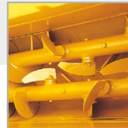
Doppelvorpresse-schnecken mit Mischpaddeln im Zulaufschacht
