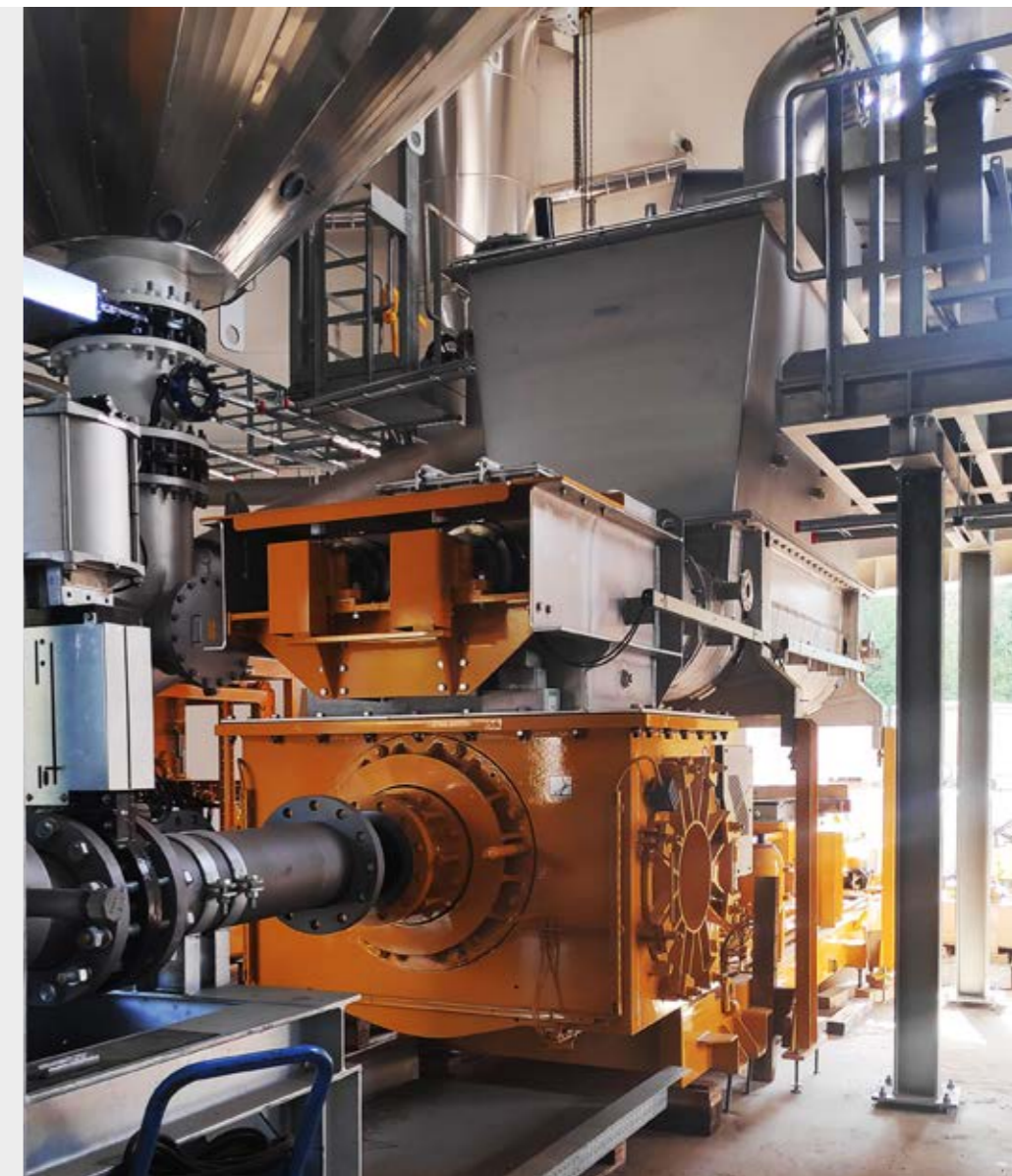
KOS 25100 mit Hydraulikaggregat und Doppelschneckenförderer für den Transport der Biomasse zum Gärtank
