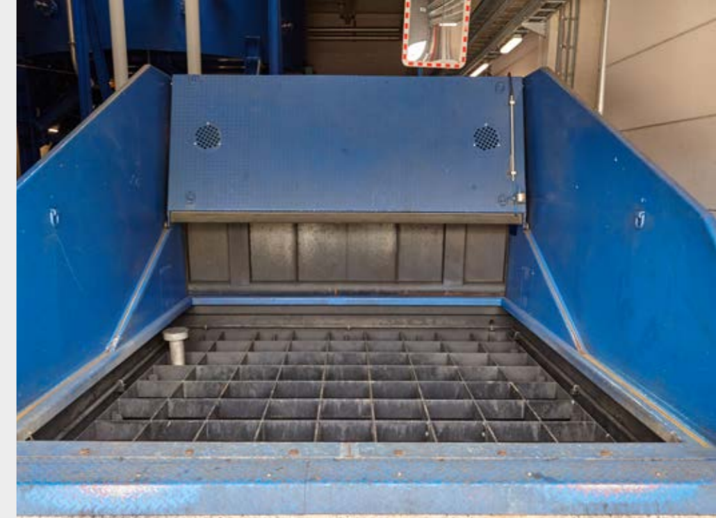
Yukarıdaki: Karşılama bunkerlerinin önemli bir özelliği olan otomatik olarak kontrol edilen flapler, Putzmeister tarafından çok çeşitli değişik varyantlar için tekliflendirilebilmektedir.
