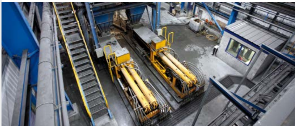
Dois bombas HSP 25100 com controle PCF para reduzir picos de pressão (Mina Lisheen de Chumbo/Zinco, Irlanda)
