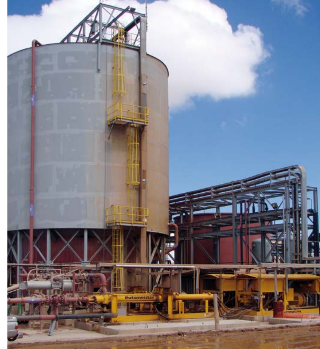
HSP 25100 HP – Bomba de alto desempenho para rejeitos de mineração e cinza volante
