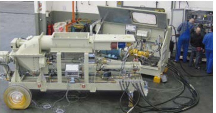
Standart ve orta yüksek voltajlar için Aichtal'daki test standında duran KOS
