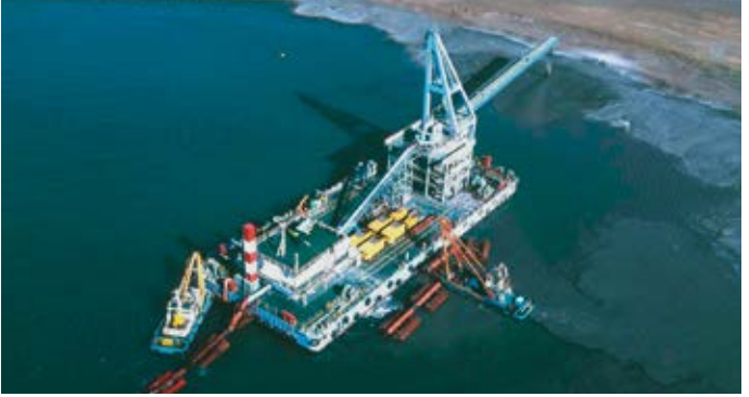
KOS 25100 ve 25200 üç devasal Piston Pompası, yapay bir ada yükselmesi için Japon sahil şeridine denizden silt pompalanmaktadır.
