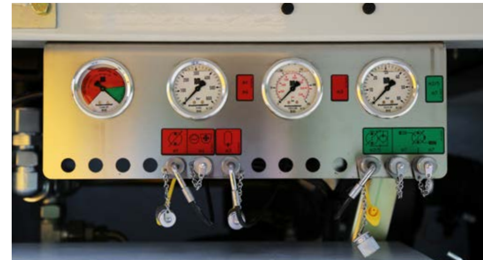
Ministión de medida: todos los puntos hidráulicos de medición se pueden leer en un punto central (BSA de la generación más nueva)
