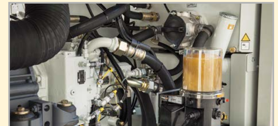
La lubricación de grasa central electrónica ahorra tiempo de trabajo y minimiza el desgaste
